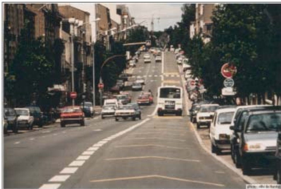
Avant 1993 : un sens unique à 2 voies de circulation, un couloir bus à contresens
